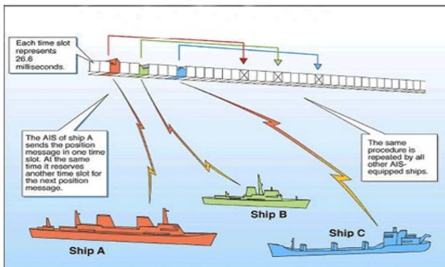
Illustration 3: L'AIS, la technologie SOTDMA
