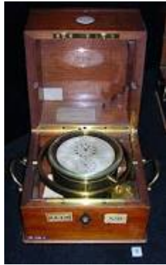
Illustration 5: chronomètre marine à suspension (XIXe)
