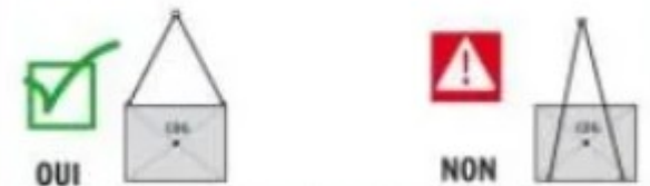
Fig. 20 Position du centre de gravité de la charge
