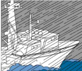
Lorsque la *pluie est verglaçante*, une couche de glace se forme sur les ponts, les rambardes et les échelles. Ce type de givrage est le moins susceptible de causer des problèmes de stabilité, mais il peut être très dangereux pour les membres de l'équipage qui marchent sur le pont.
